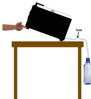
Photo 6 : drainage du liquide de nettoyage
