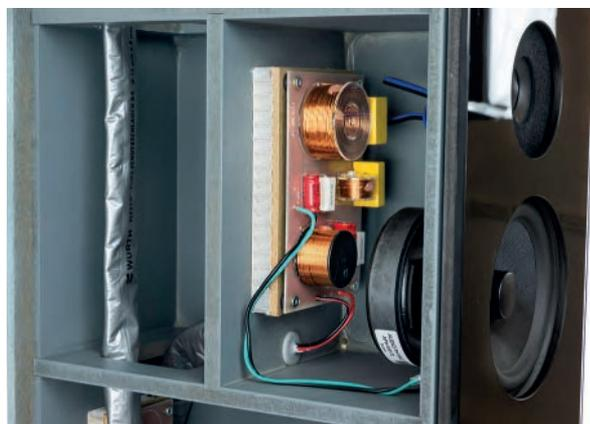
Sandwich-Boards mit Wabenstruktur kommen als entkoppelte Bauteileträger für die Frequenzweichen zum Einsatz. Der flache Phaseplug des Mitteltöners sorgt für die thermische Optimierung des Treibers
