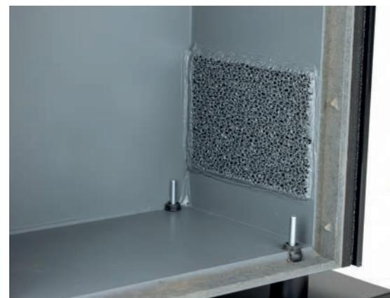
Die Keramikschaumplatte sitzt in der Classic 35 als dämpfendes Element vor der Bassreflexöffnung und hilft, Strömungsgeräusche zu minimieren
