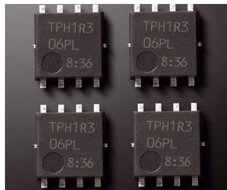
Die Schalttransistoren beeindrucken mit winzigen Übergangswiderständen und gewaltiger Strombelastbarkeit
