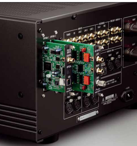
Die beiden Modulsteckplätze des E-800 können mit einem Phono- und einem D/A-Wandlermodul bestückt werden
