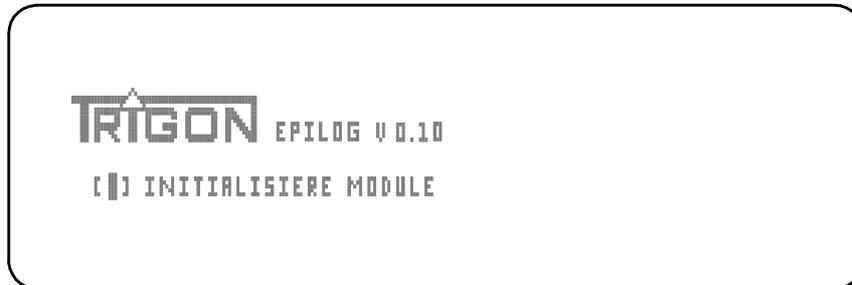
Der Mikroprozessor prüft nun, welche Module vorhanden sind. Es muss immer mindestens ein Eingangsmodul vorhanden sein, damit eine sinnvolle Konfiguration gegeben ist und es zu keiner Fehlermeldung kommt.
