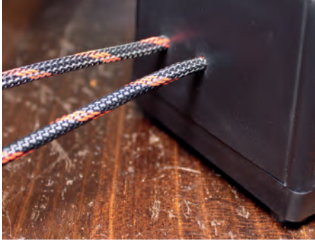
Anschlusskabel für Kompressor und Motor an einer Seite des Netzteils
